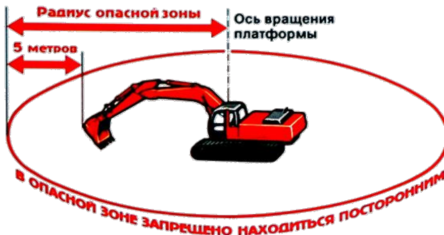
Рис.25. Граница опасных зон при работе экскаватора
